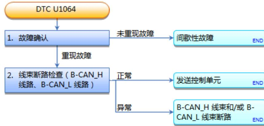
**DTC U1064:** 座椅加热器控制单元与气温控制单元失去通信
